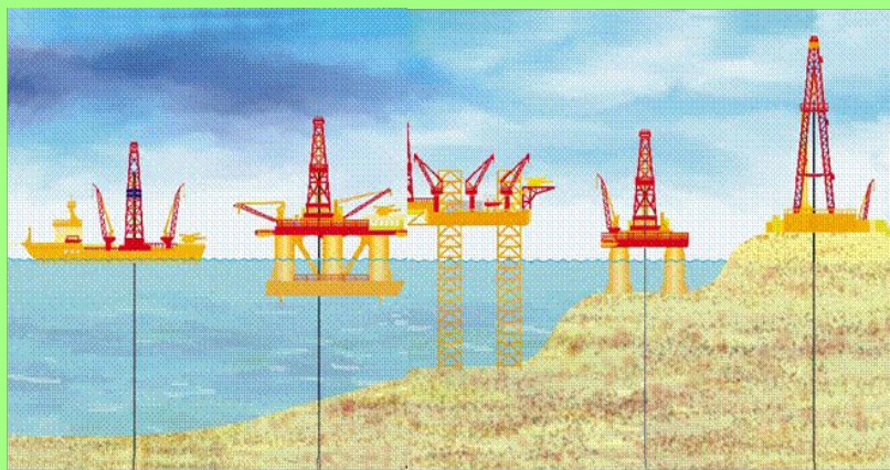
Рис. 4. Виды буровых скважин
