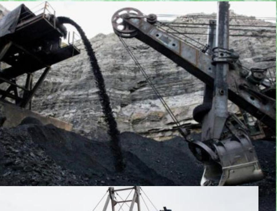
Шахта, чтобы складывать уголь, слишком мала, уголь поднимают на поверхность с помощью специальной техники похожей на эскалатор. «Приезжает» уголь прямо на погрузочный пункт, где с помощью экскаватора его грузят на КАМАЗы или в вагоны поезда.
