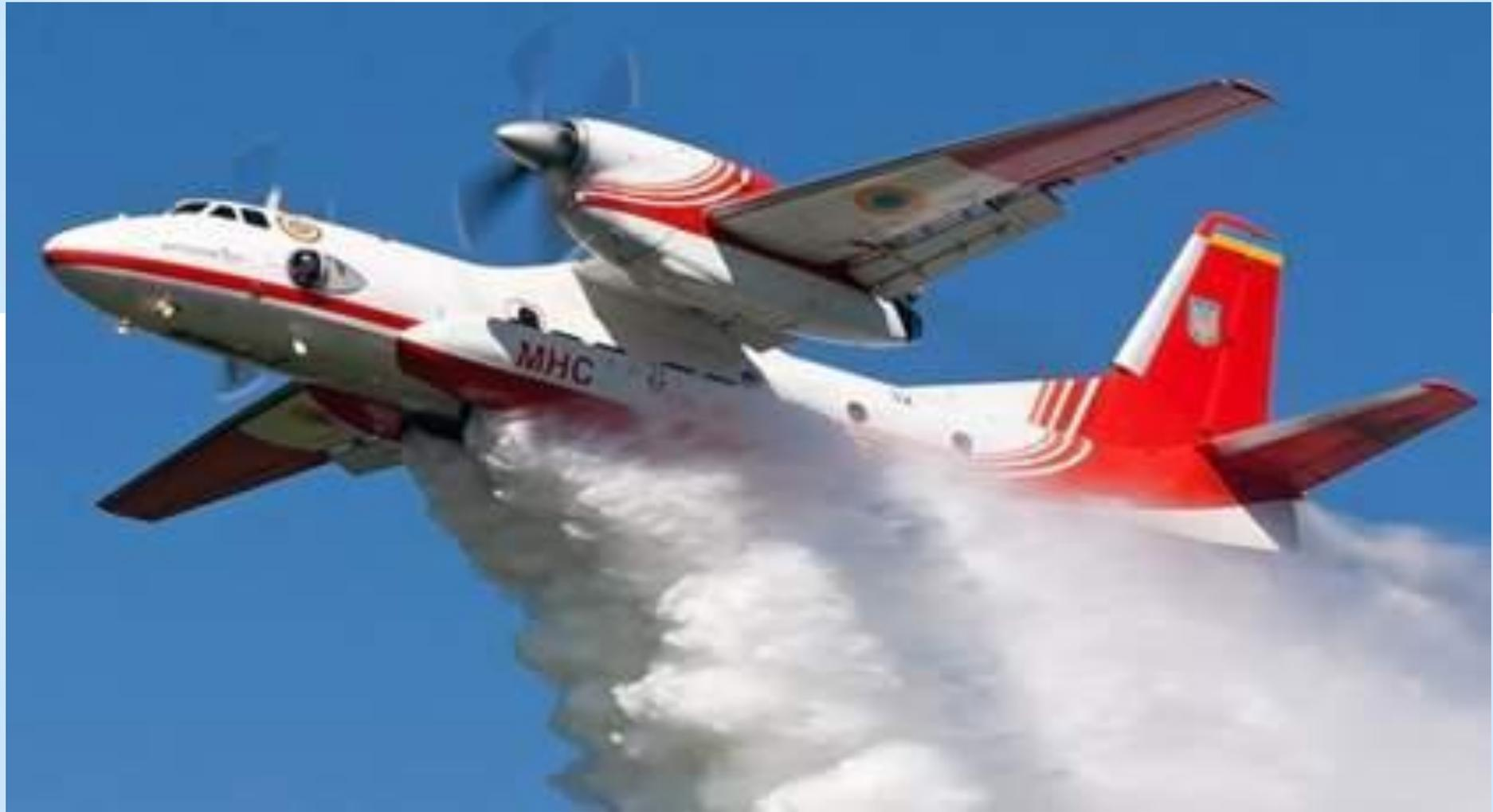
**Пожарный самолёт предназначен для тушения пожаров путём водной бомбардировки - сброса воды с борта самолёта на пожар.**
