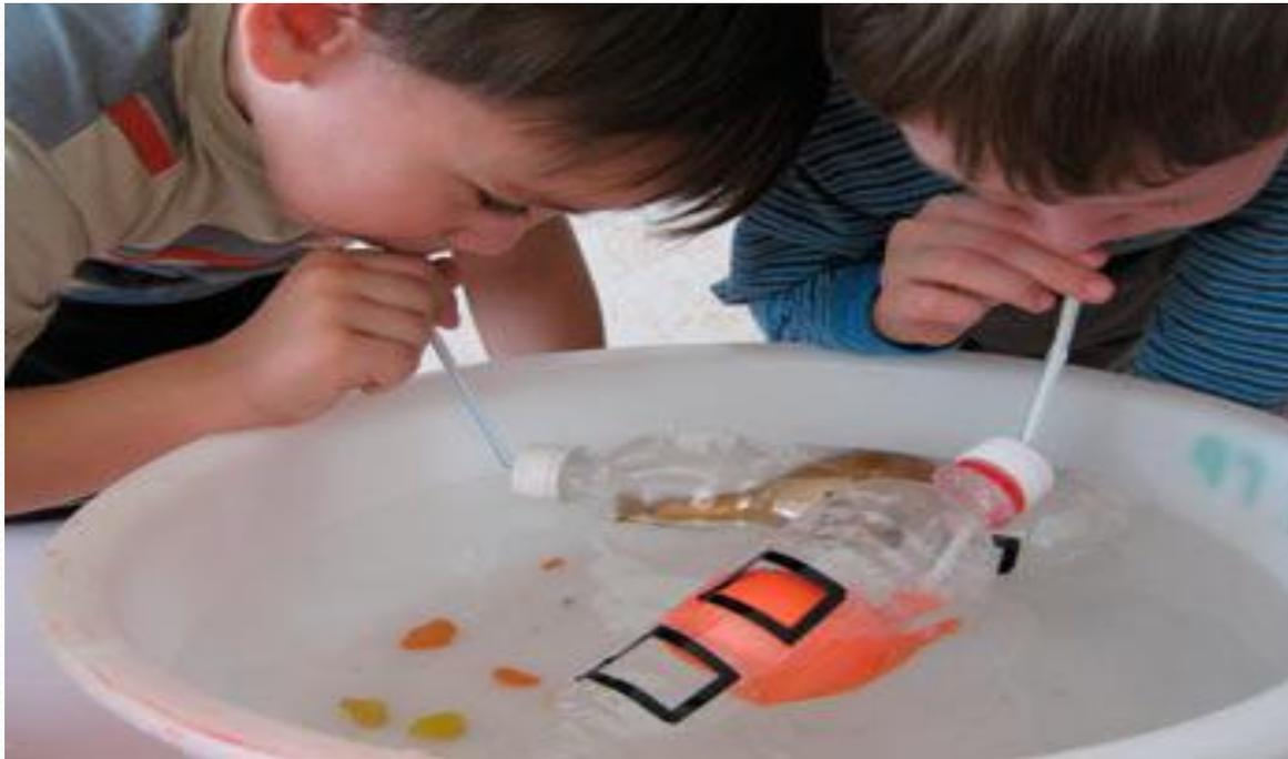
Мы все можем в домашних условиях сконструировать подводную лодку. Я провел конструирование подводной лодки, внутри которой находится воздушный шарик с трубочкой. Отверстия в виде иллюминаторов помогают заполнить лодку водой, она погружается на дно. Надувая воздушный шар, мы выталкиваем воду из пластиковой бутылочки, и лодка всплывает к поверхности.
