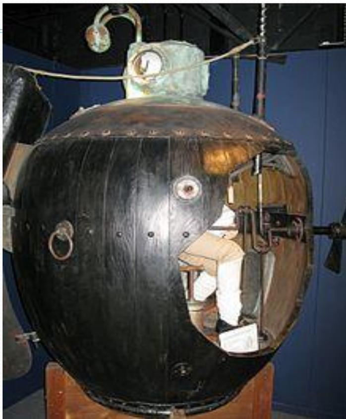
Дэвид Бушнелл – американский изобретатель построил модель подводной лодки в 1776 г., впервые предназначавшейся для атаки врага и погружающуюся при заполнении специального бака водой. Лодка получила название «Черепахи» из-за внешнего сходства двух половин судна, спаянных между собой и напоминающих панцирь черепахи. В верхней половине был купол со стеклом. Однако при первой же попытке атаки лодка была уничтожена английским флотом.
