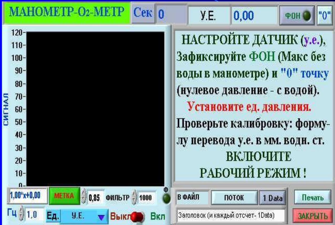
Регистрация давления в манометре Варбурга электро-оптическим методом.
