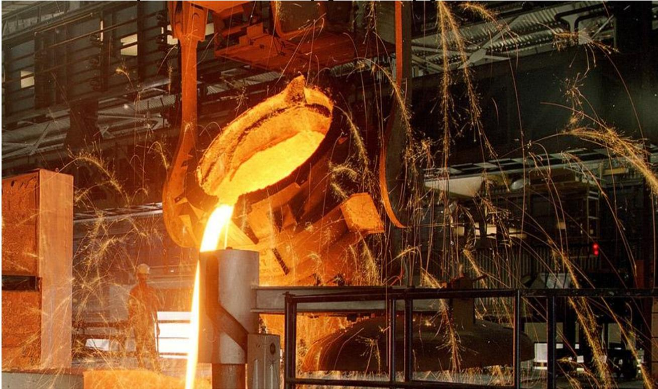
3.Путь этого ковша- в соседний цех. Тут чугун выльют в формы. В них жидкий металл застынет и примет ту или иную форму. Это: чугунные сковородки, чугунки, батареи отопления.
