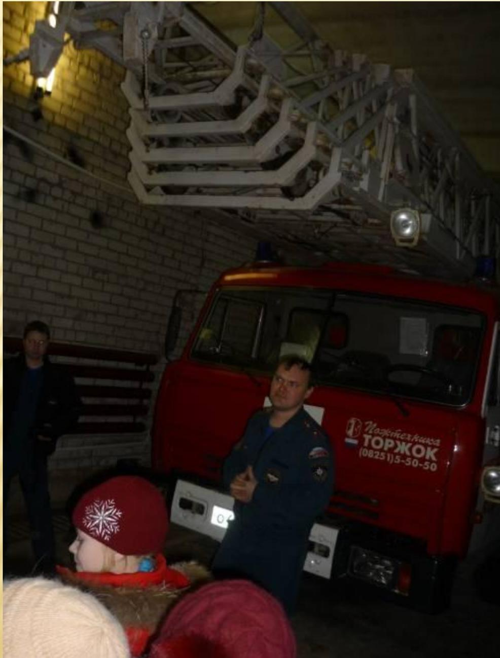
Особое внимание привлекла пожарная машина на базе КАМАЗа. Ее стрела в вытянутом положении достигает высоты 50 метров, содержит грузоподъемные лифты.
