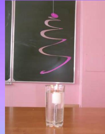
Вывод: Температура воздуха над нагревателем начинает повышаться. Горячий воздух поднимается и вступает в контакт с бумажной спиралью, проходя между ее витками. Воздух давит на витки, заставляя спираль вращаться.
