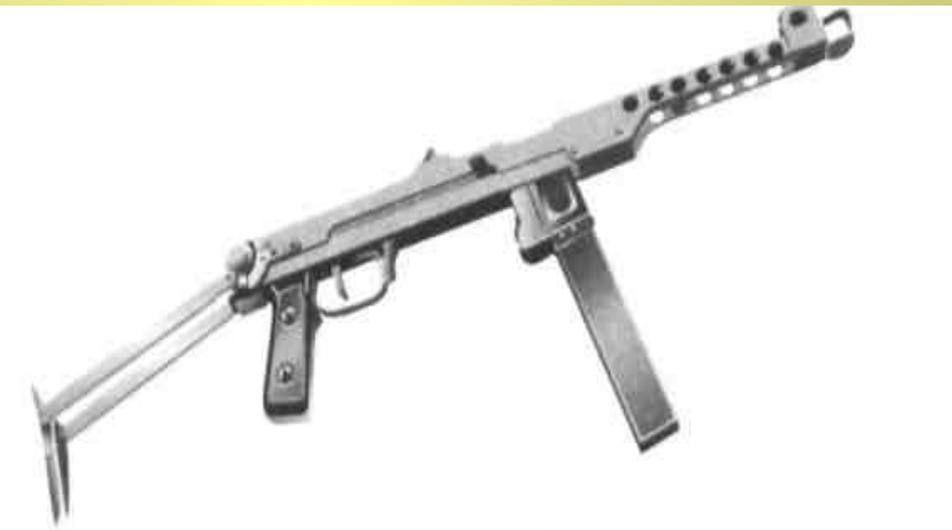
**Пистолет-пулемет А. Судаева (ППС) образца 1943 года имел складной металлический приклад, его вес был меньше ППШ на 1,63 кг**
