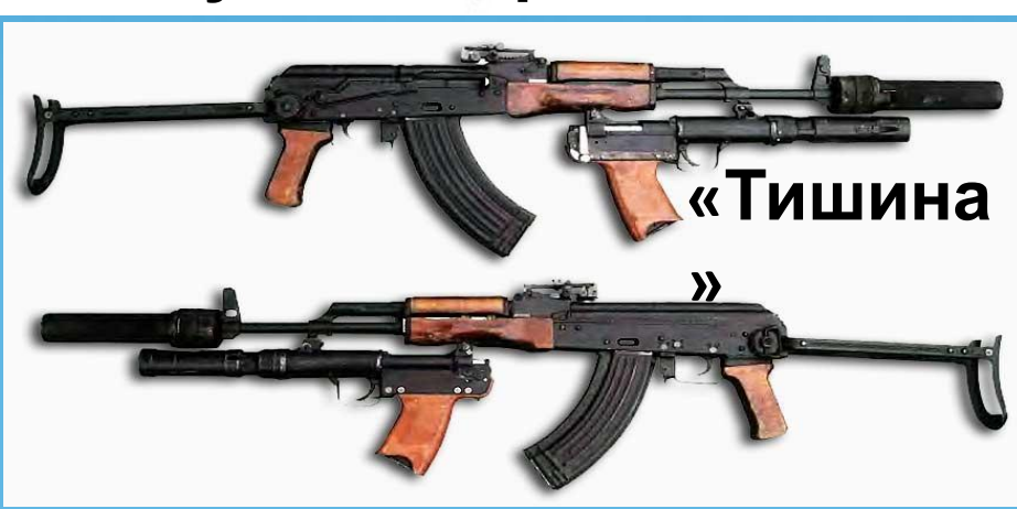
7,62-мм АКМС с прибором бесшумной стрельбы ПБС-1.
