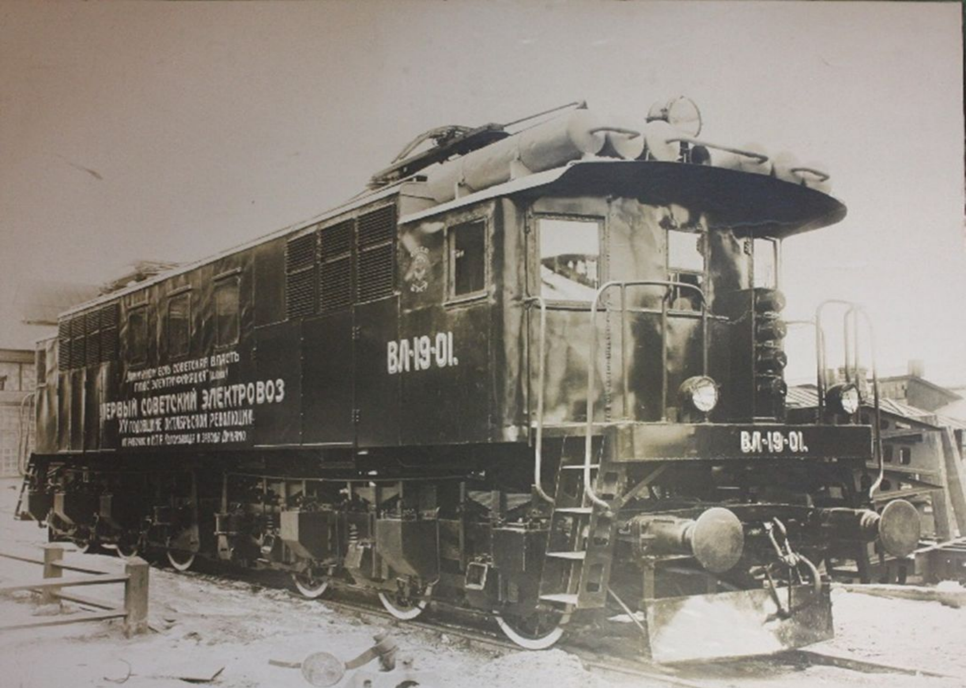
Электровоз 114 тонн, постройки Коломязавода 1932 г.
