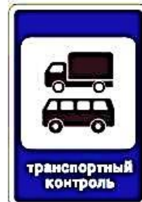
7.14 Пункт контроля международных автомобильных перевозок
