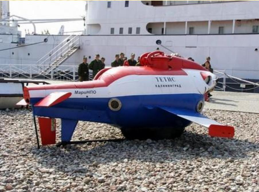
*ПОДВОДНЫЙ ОБИТАЕМЫЙ АППАРАТ "ПАЙСИС-У11" . САМОХОДНЫЙ АППАРАТ. ПРЕДНАЗНАЧЕН ДЛЯ СБОРА НАУЧНЫХ ДАННЫХ И ВЫПОЛНЕНИЯ ПРИКЛАДНЫХ РАБОТ В ТОЛЩЕ ОКЕАНА И НА ДНЕ.*
