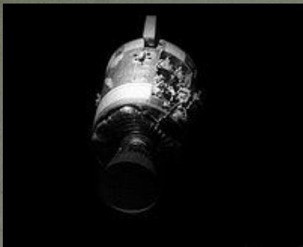
Поврежденный двигательный отсек «Аполлона-13» после отделения
