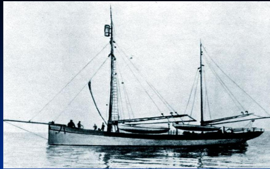
Экспедиция отправилась на небольшом (около 64 тонн водоизмещения) зверобойном судне "Геркулес", приспособленном для плавания во льдах. Кроме парусного вооружения, судно имело 24-сильный двигатель и обладало прекрасными мореходными качествами. Капитаном "Геркулеса" Русанов пригласил А. С. Кучина - образованного моряка и опытного полярника. В экспедицию вместе с Русановым отправлялась его невеста Жюльетта Жан - геолог и врач.
