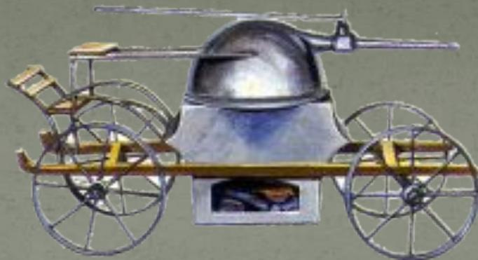
Так же в работах Ньютона, относящихся к 1663 году, был найден чертёж тележки, приводимой в движение **паровым реактивным** двигателем. Котел с водой поставлен на колеса. Внизу помещается топка. Струя пара, вырываясь из котла с большой скоростью, действием, так называемой реактивной силы, заставляет тележку двигаться в противоположном выходу пара направлении, т. е. вперёд, подобно ракете.
