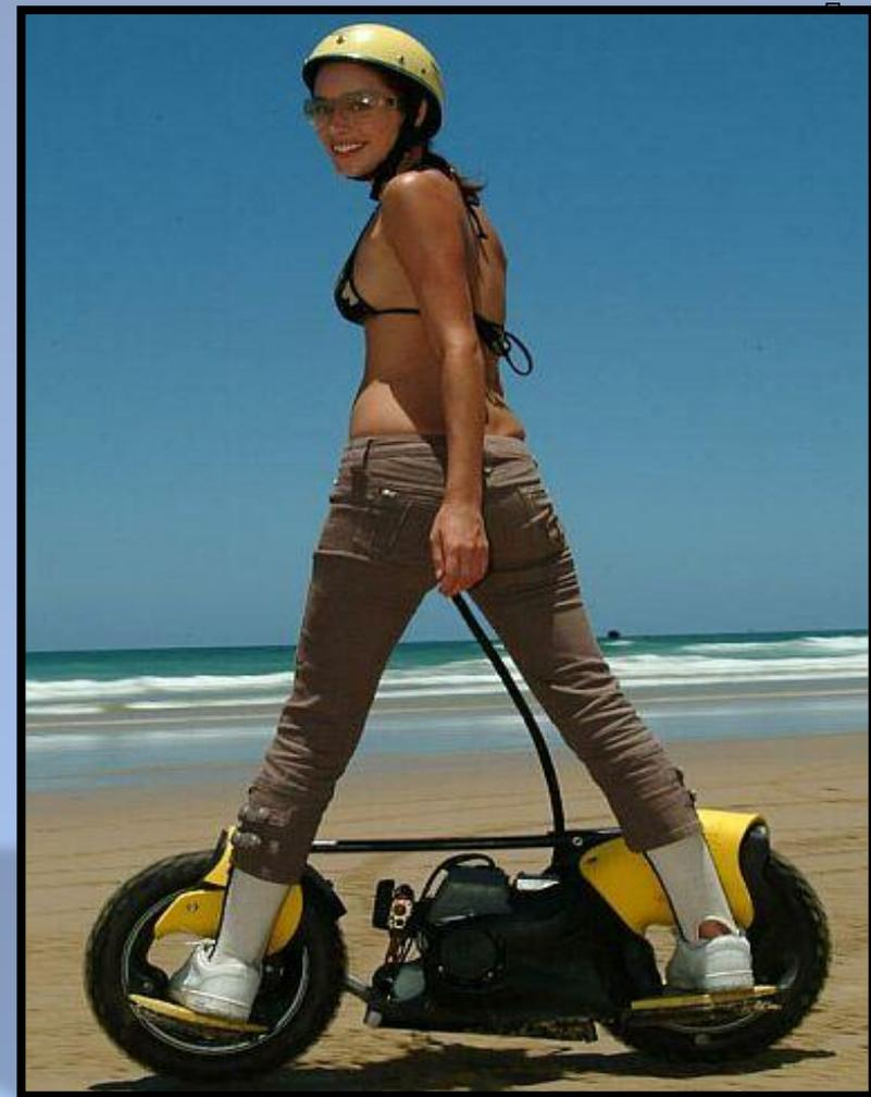
Самокат G-Motion имеет два колеса, но лишен руля и сиденья для ездока. G-Motion управляется подобно скейтборду, когда наездник использует наклон тела для поворота в нужную сторону. Максимальная скорость этого гибрида составляет около 30 км/ч. В отличие от скейта, на G-Motion нельзя запрыгнуть с разбега, так как ступни ездока находятся внутри 10-дюймовых колес. Высота G-Motion 30 см, длина около метра, масса 22 кг, при этом самокат выдерживает наездника весом до 120 кг.
