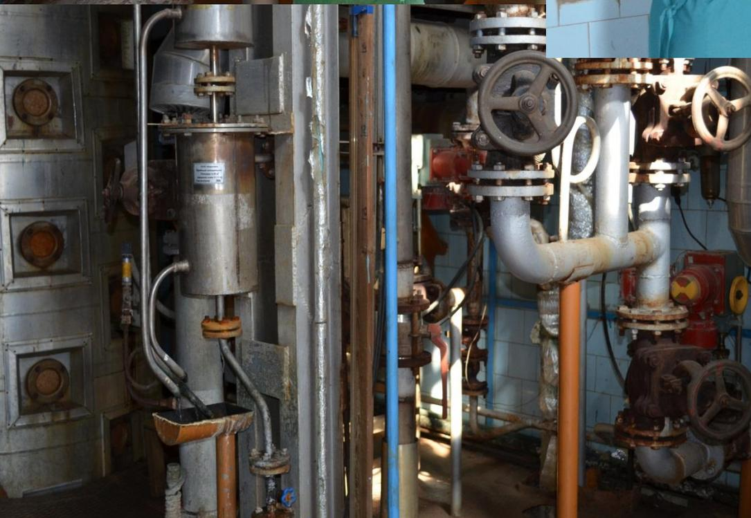
Готовая бражка насосом подается в цех брагоректификации, где установлена брагоректификационная установка 4-колонная производительностью 2000 дал/сутки.
