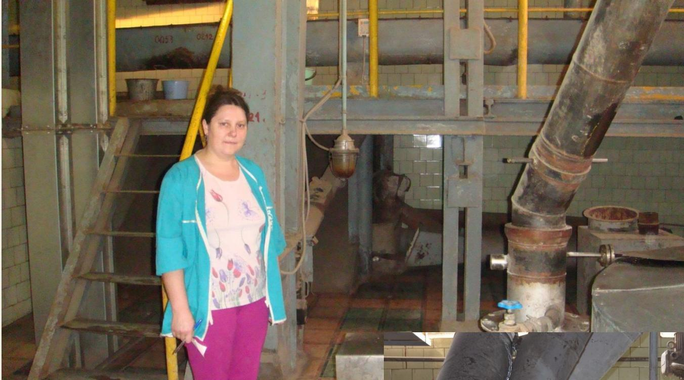
Из расходных бункеров зерно через винтовой конвейер и норю подается на весы автоматические порционные, затем зерно самотеком поступает на дробилку молотковую.
