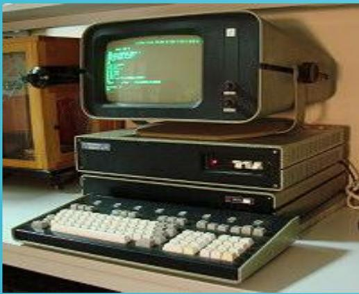
Советская микро-ЭВМ ДВК-2 в формате персонального компьютера. Сверху вниз: алфавитно-цифровой дисплей (терминал) 15ИЭ-00-013, блок логики дисплея, блок сопряжения, клавиатура (дисководы размещаются снаружи и на фото не показаны)
