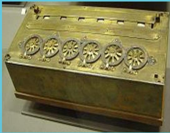
1642 год — Блез Паскаль представляет «Паскалину» — первое реально осуществлённое и получившее известность механическое цифровое вычислительное устройство. Прототип устройства суммировал и вычитал пятиразрядные десятичные числа. Паскаль изготовил более десяти таких вычислителей, причём последние модели оперировали числами с восемью десятичными разрядами
