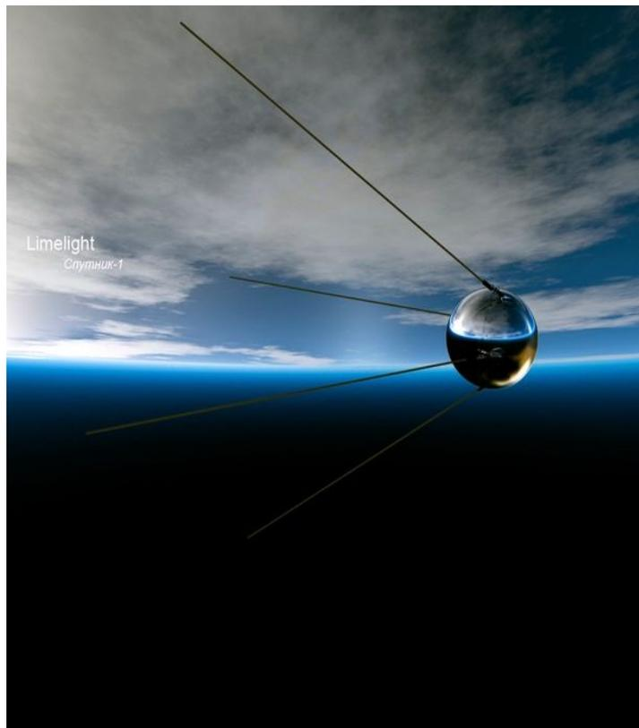
**Масса первого ИСЗ 83,6 кг, сфера диаметром 580 мм, на котором установлены четыре антенны длиной 2,4 м и 2,9 м.**
