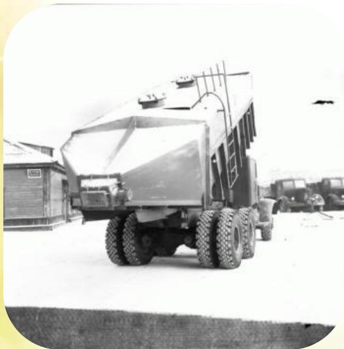
Его возили с завода на плотину в специальных самосвалах, кузова которых имели двойные стенки и прогревались циркулирующими между этими стенками выхлопными газами.
