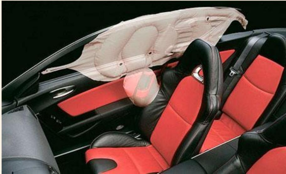
**Из-за того, что подушки безопасности срабатывают лишь раз и затем быстро сдуваются, они бесполезны при последующем столкновении.**
