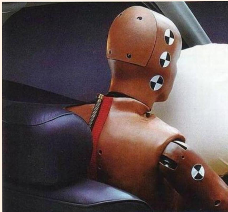
Пневмоподушка дополняет ремень безопасности, уменьшая шанс удара головы и верхней части тела пассажира о какую-либо часть салона автомобиля. Также они снижают опасность получения тяжелых травм, распределяя силу удара по телу пассажира.
