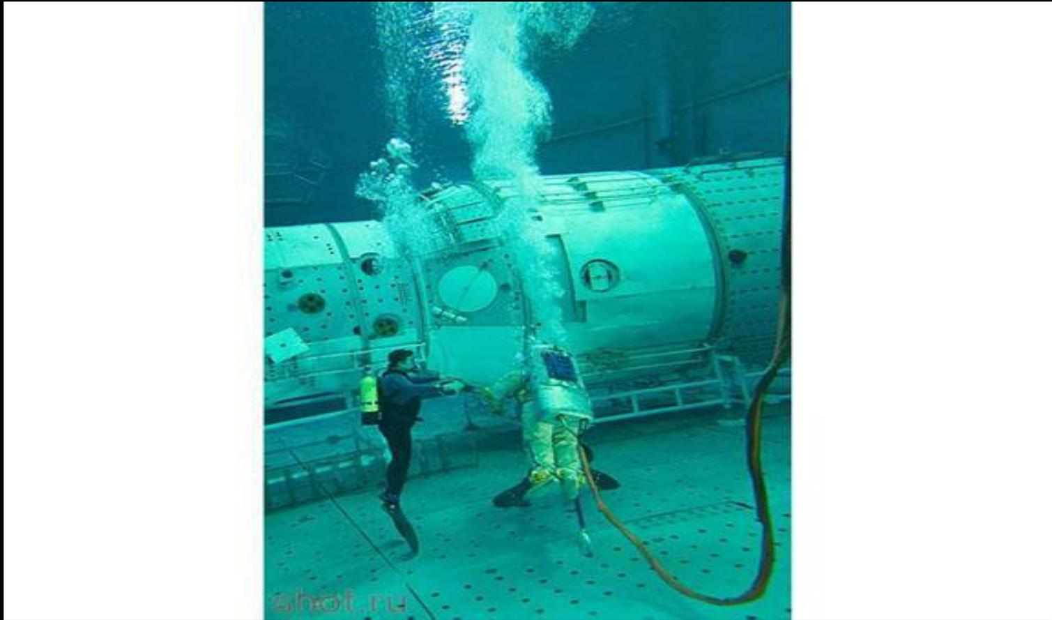
Когда проводятся тренировки под водой, станцию вместе с платформой, подготавливаемыми космонавтами и водолазами опускают под воду, в гидробассейн.
