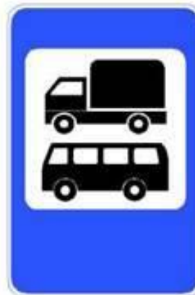
6.13 Пост транспортного контроля
