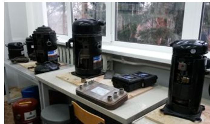
Разборные конструкции поршневых и спиральных компрессоров
