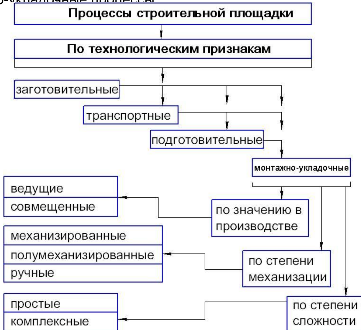
Рис.1.1 Схема классификации строительных процессов
