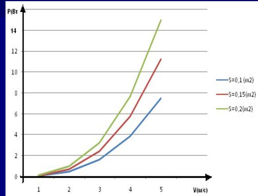
Для увеличения мощности (выходного напряжения) генератора необходимо увеличивать площадь лопастей ветряка этого можно добиться используя разные винты, которые в походных условиях не так трудно сделать из пустых пластиковых бутылок разной ёмкость..
