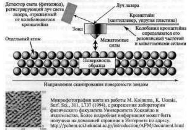
Рис. 10. Принцип работы атомно-силового микроскопа
