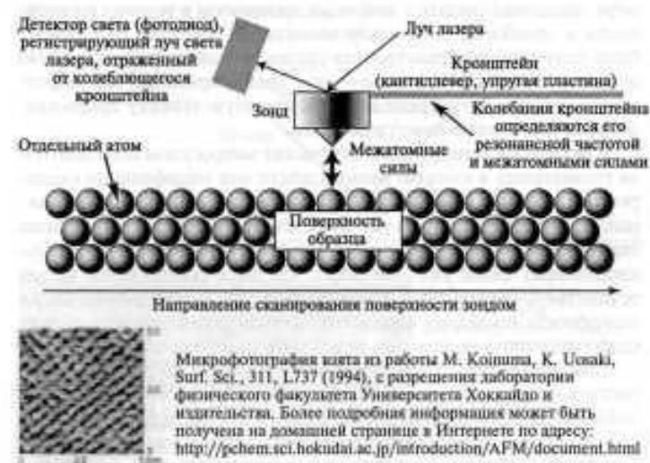
Рис. 10. Принцип работы атомно-силового микроскопа
