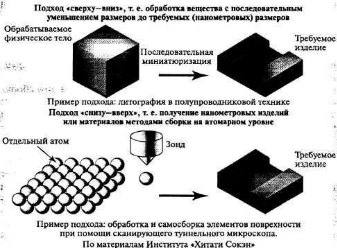
Рис. 4. Два главных нанотехнологических принципа обработки материалов
