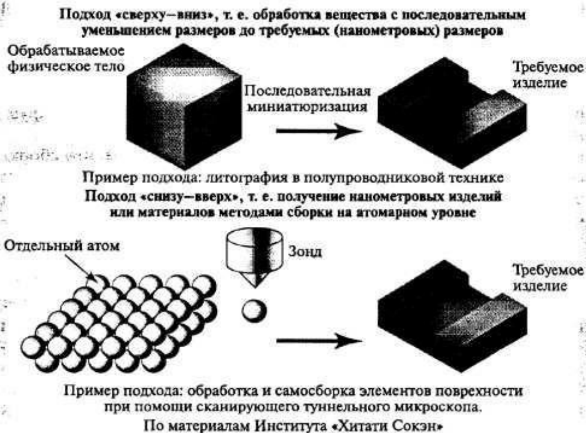
Рис. 4. Два главных нанотехнологических принципа обработки материалов
