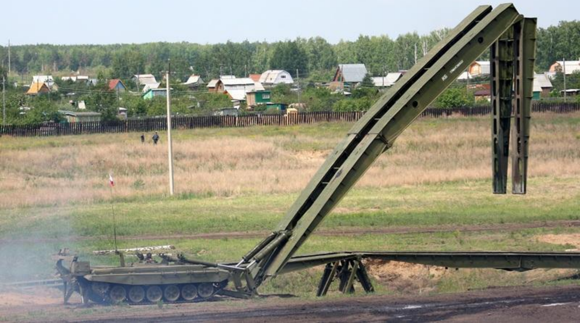
Танковый мостовкладчик МТУ-90 во время укладки моста.
