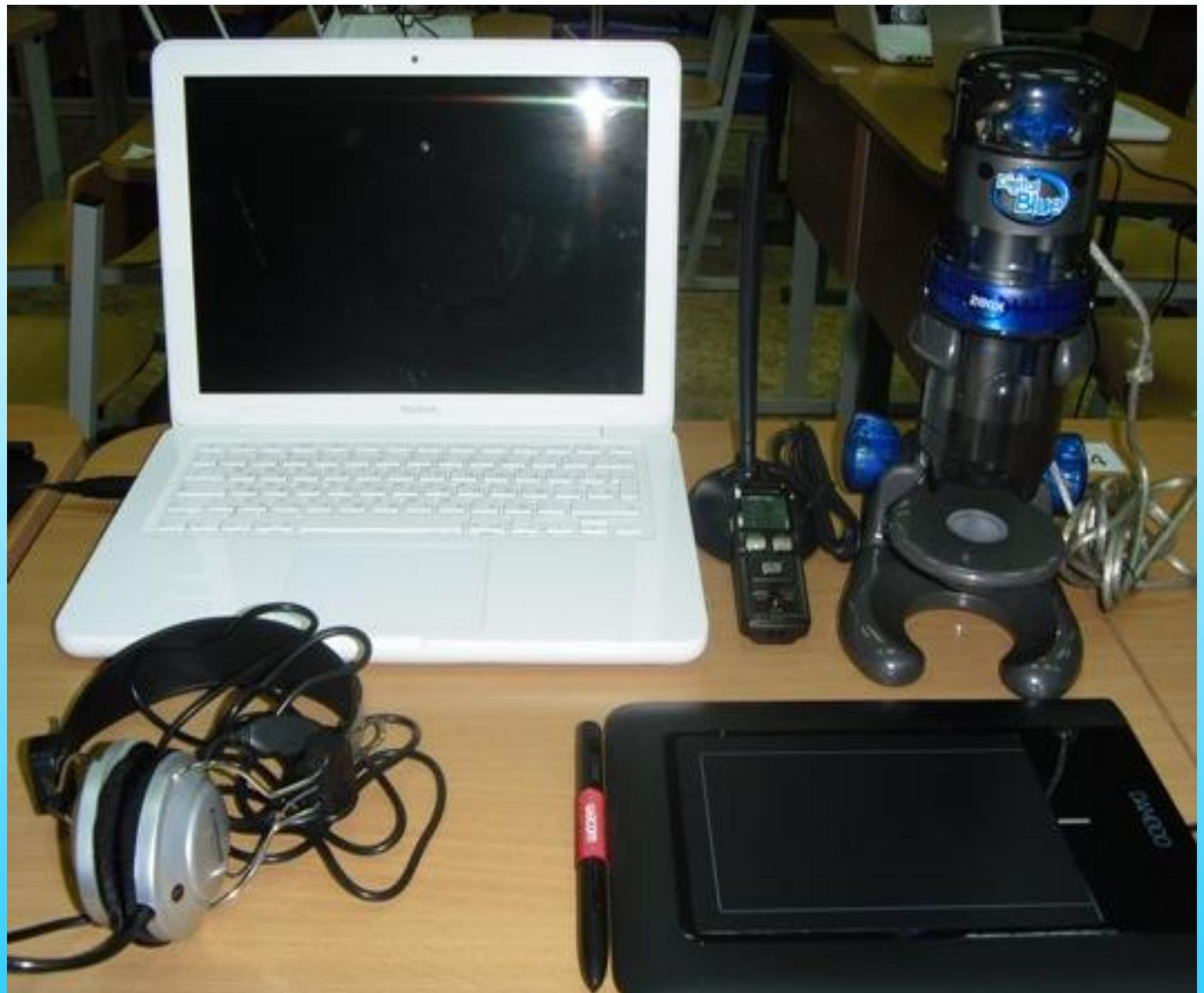
**Цифровой микроскоп– это микроскоп, укомплектованный цифровой системой ввода изображений, с помощью которой изображения передаются в компьютер. Цифровой микроскоп дает возможность не просто наблюдать микро объекты, но и документировать изображения с помощью установленной на микроскоп системы ввода, а при необходимости и проводить измерения на изображениях и их анализ с помощью программного обеспечения.**
