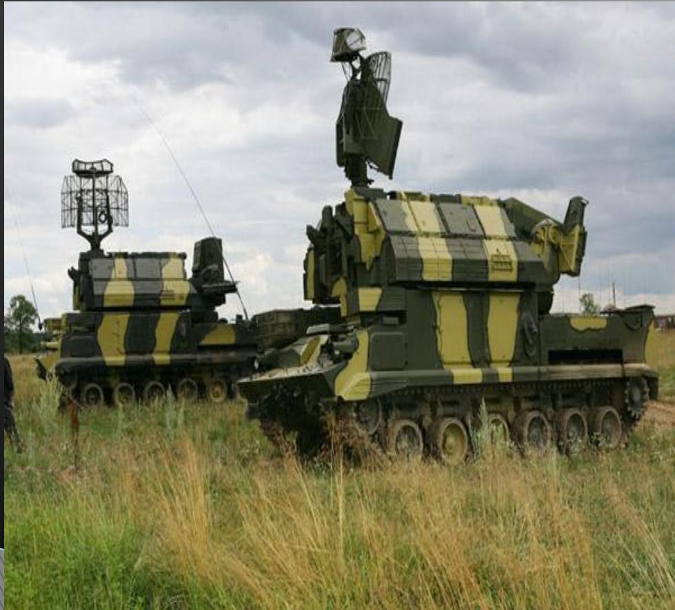
Автономный самоходный зенитный ракетный комплекс (ЗРК) 9К331 "Тор-М1" предназначен для противовоздушной обороны мотострелковых и танковых дивизий во всех видах боевых действий и в районах сосредоточения, защиты наиболее ответственных объектов .
