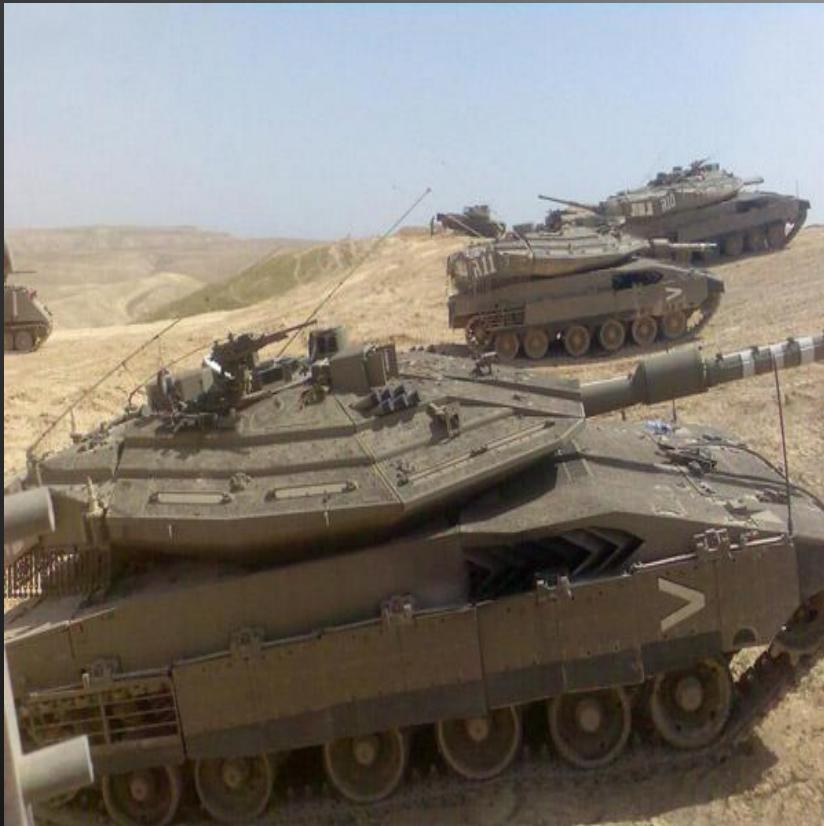
Является одним из самых защищенных танков в мире. Танк может стрелять различными 120-мм снарядами и ракетами. Каждый снаряд, храниться в защитном контейнере, для защиты экипажа в случае взрыва боеприпасов. танк может перевозить восемь военнослужащих или трех раненых. Для мобильной загрузки и выгрузки приспособлен задний люк. Стоимость МЕРКАВА 5 000 000 \$
