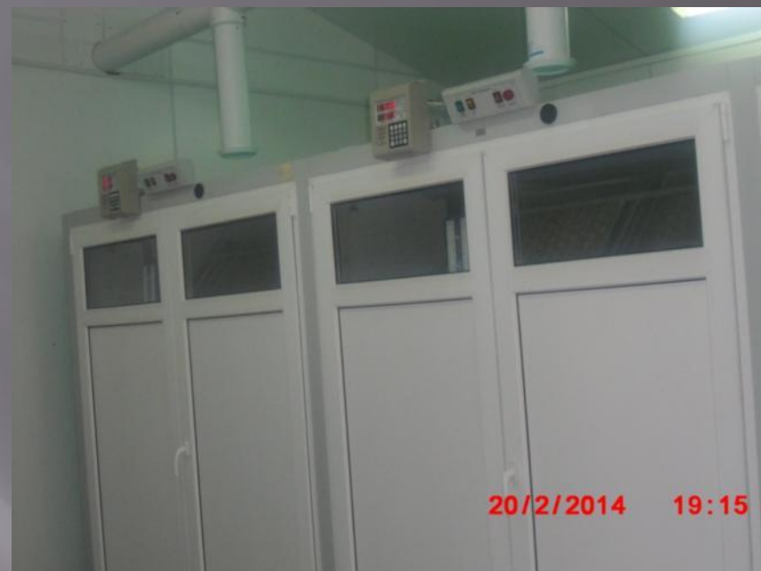
Инкубаторские ящики с датчиками регулировки воздуха и обогрева яиц.
