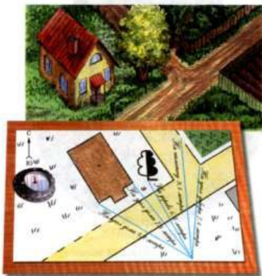
Рис. 47. Полярная глазомерная съёмка
