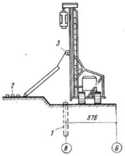
Наиболее распространены в промышленном и гражданском строительстве сваи длиной 6... 10 м, их забивают с помощью самоходных сваебойных установок, изготовленных на базе кранов, тракторов, автомобилей и экскаваторов.
