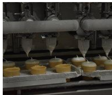
Наполнение стаканчиков мороженым автоматически
