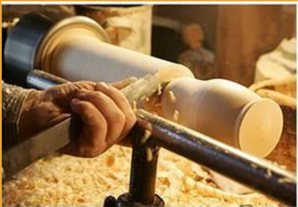
1. Вытачивание изделий на станке
