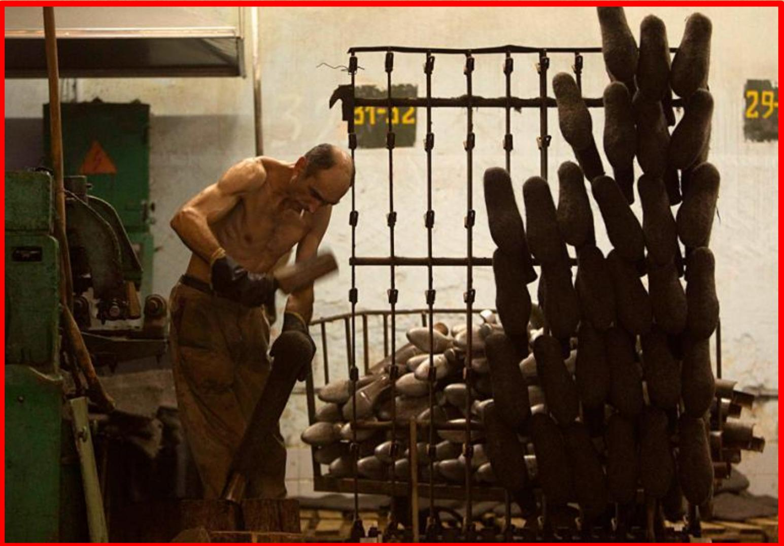
Потом заготовку натягивают на колодку и старательно отбивают со всех сторон деревянной колотушкой, пока изделие не примет форму обычного валенка и будет нужного размера.
