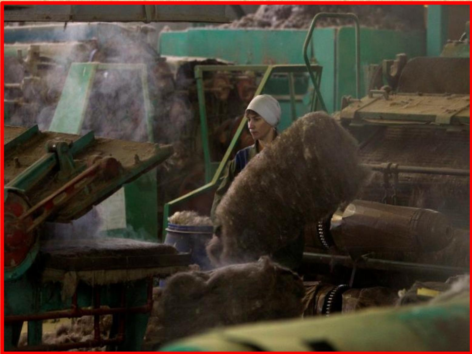
Прогоняют через шерстобитную машину, в результате получается тонкое мягкое полотно.
