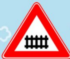
Железнодорожный переезд со шлагбаумом
