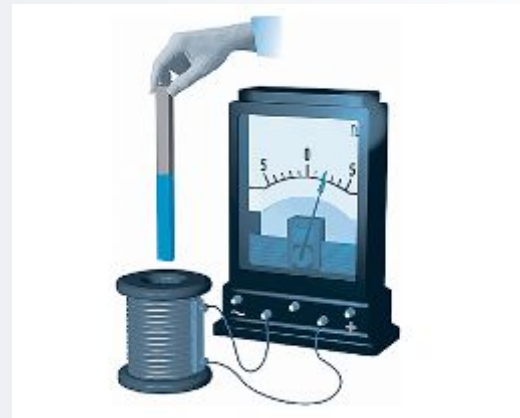
Возникновение тока при действии пост. магнита на катушку
