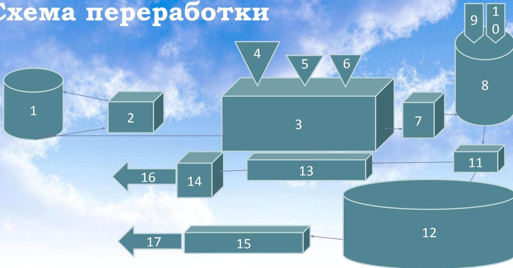
Разделение на сухую и жидкую фракции на центрифуге (11) с дальнейшим процессом гранулирования (13), фасовкой в мешки (14) и одновременным сливом в ёмкость хранения (12) с добавлением биологического компонента, который в течении 2 суток при температуре не ниже +20 С перерабатывает остатки органических соединений и других элементов до нормализации минерального состава, уровня ХПК, БПК, кислотности, что позволяет сливать данные жидкие остатки в открытые водоемы.
