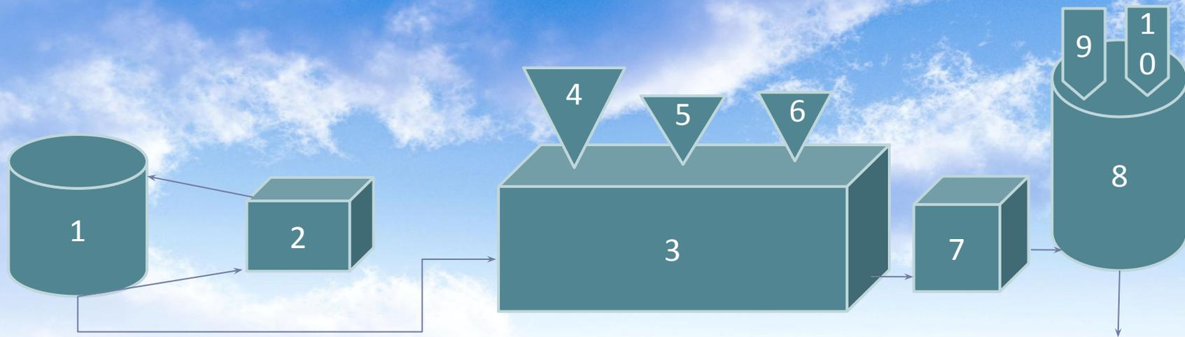
**Обеззараживание массы в активаторе (3) процессов и дробление её до стадии полной стерильности с одновременным введением компонента «А» (4). Введение активатора (5). Далее введение компонента «В» (6). Далее масса под воздействием активатора разогревается до температуры 45 градусов, после этого поступает в поточный охладитель (7) где охлаждается до 30 градусов, после этого поступает в промежуточную технологическую ёмкость (8) с мешалкой, где вводятся компоненты «С» (9) и «D» (10).**
