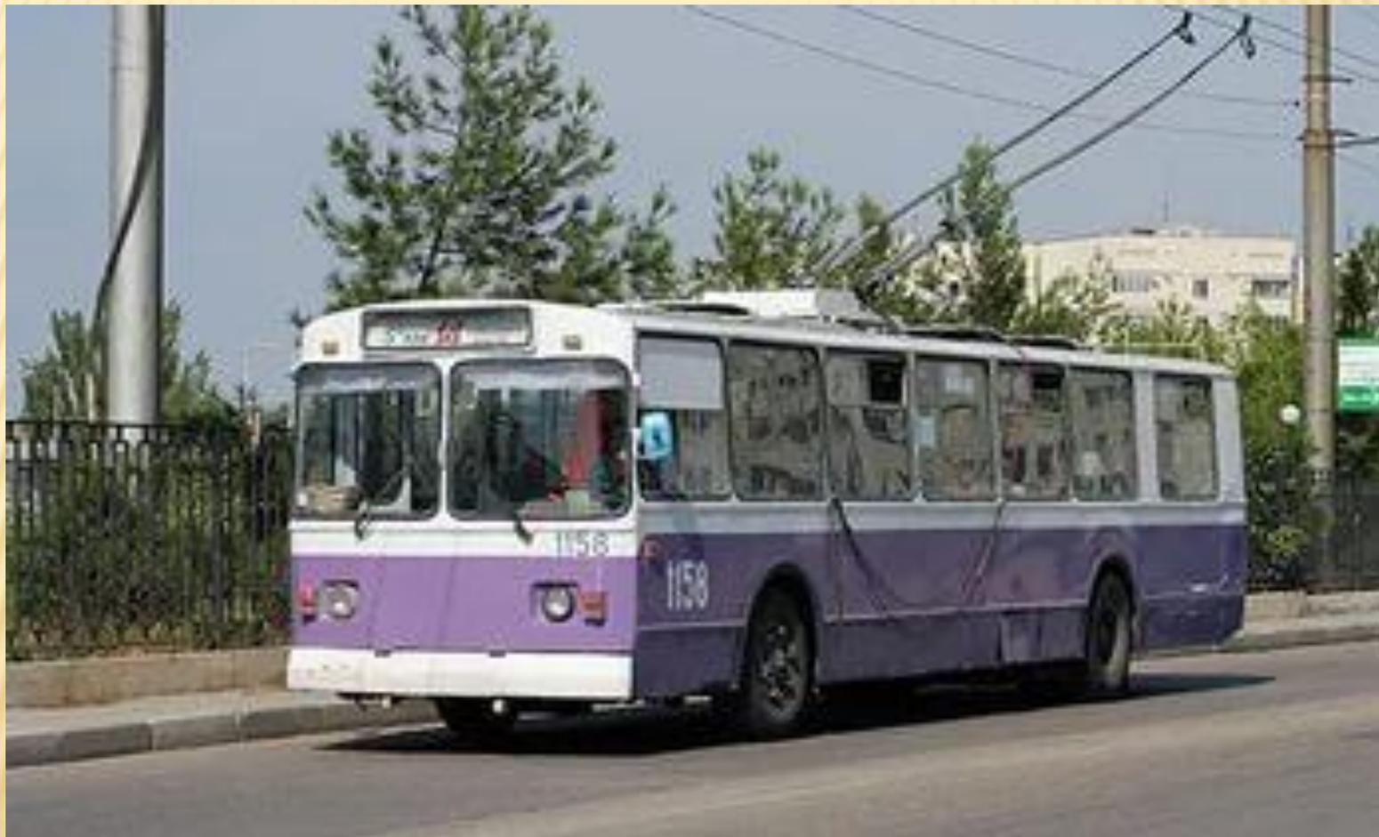
**Троллейбус** — безрельсовое механическое транспортное средство (преимущественно пассажирское, хотя встречаются **троллейбусы** грузовые и специального назначения) контактного типа с электрическим приводом.
