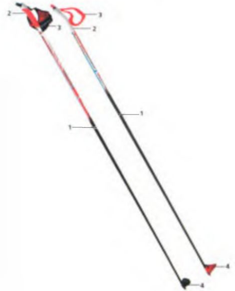
Рис. 33. Лыжная палка и ее детали: трубка - 1, рукоятка - 2, ремешок (петля, темляк) - 3, кольцо (лапка, сегмент) упора с наконечником - 4
