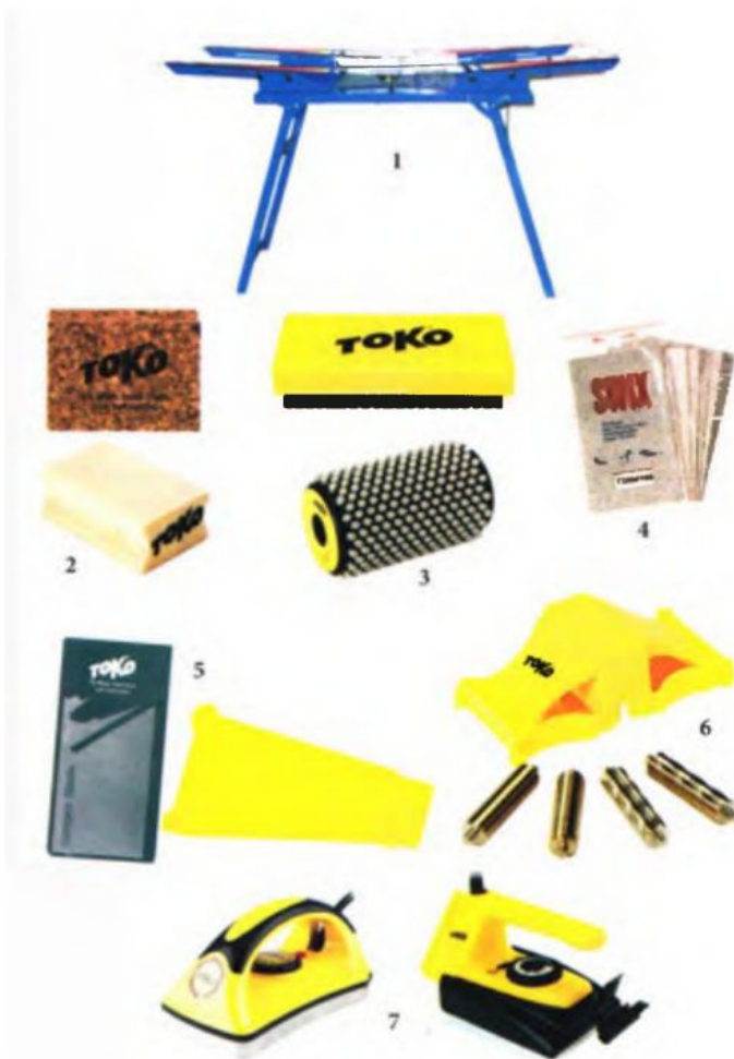
Рис. 41. Приспособления для подготовки лыж: стол-станок – 1, пробки – 2, щетки – 3, набор шкурок – 4, скребки/цикли – 5, накатки – 6, смазочные утюги – 7
