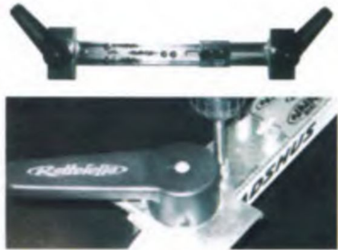
Рис. 32. Станок для монтажа креплений на лыжи
