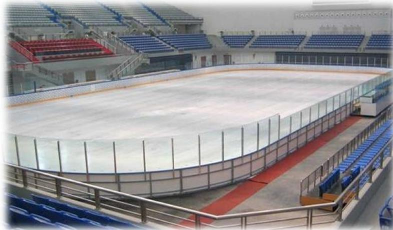
Современный крытый каток – это сложное сооружение, состоящее из специальной основы, залитой и замороженной в несколько слоёв подготовленной воды, пластиковых бортов и защиты из закалённого стекла, холодильной установки, установок для поддержания микроклимата. Также сюда можно отнести специальные машины, которые позволяют
