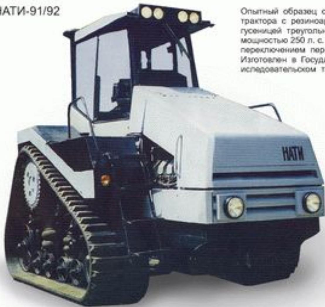
Опытный образец сельскохозяйственного трактора с резиноармированной гусеницей треугольного обвода. Дизель мощностью 250 л. с. трансмиссия с переключением передач под нагрузкой. Изготовлен в Государственном научно-исследовательском тракторном институте
