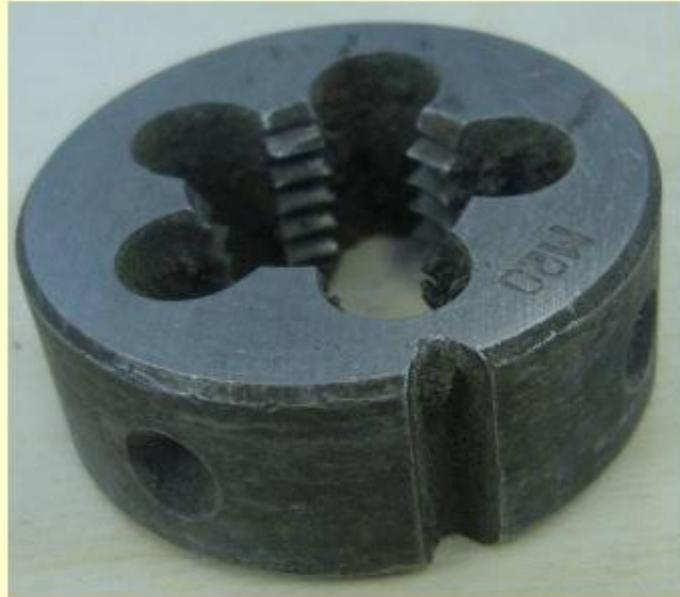
Плашку закрепляют в плашкодержателе
