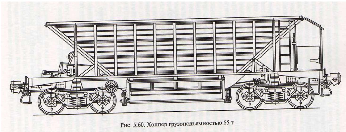
Рис. 5.60. Хоппер грузоподъемностью 65 т
