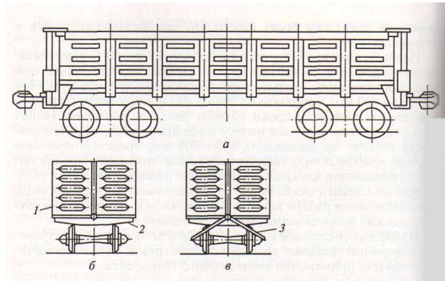
Вагоны-самосвалы(**думпкары**)-разгружаемые наклоном кузова в сторону при одновременном опускании или поднимании борта, а также комбинации этих движений. Думпкары используются для транспортирования вскрышных пород, а на рудных карьерах – полезного ископаемого
