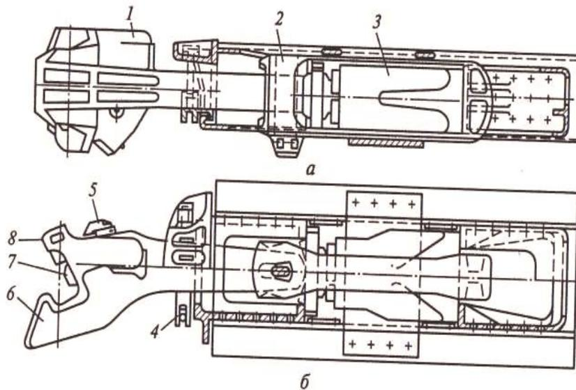
Рис. 5.66. Автосцепное устройство:
