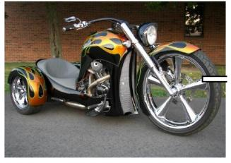
2.Трёхколёсный байк - это модифицированный мотоцикл с ДВС мощностью от 17 до 280 л.с. (2-6 цилиндров).
