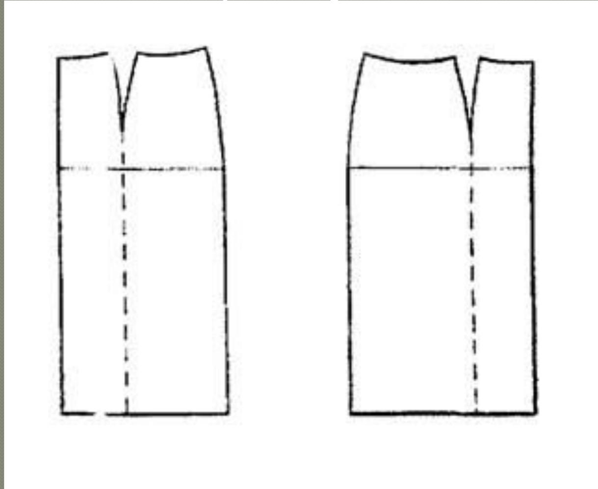
**По осевым линиям переднего и заднего полотнищ юбки провести вертикальные линии до их пересечения с линией низа и разрезать выкройки по этим линиям.**
