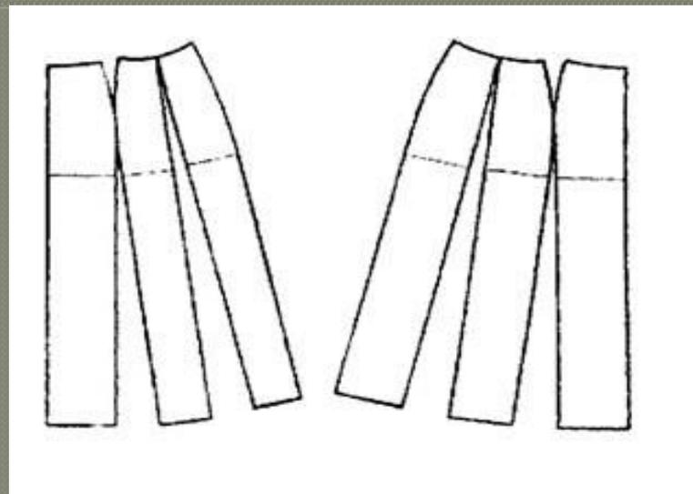
Разрезать выкройки по намеченным линиям и развернуть полученные части на нужную ширину.
