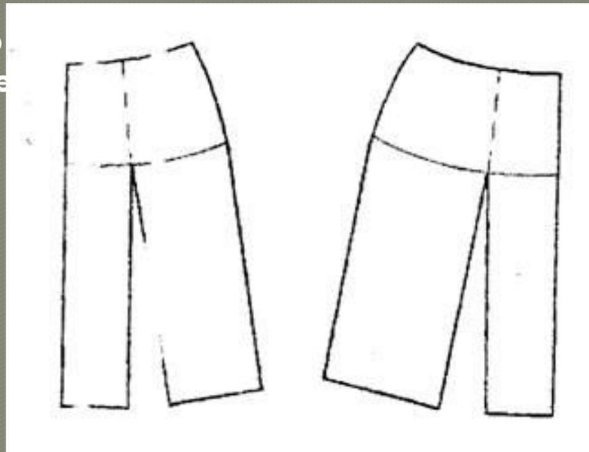
**Раздвинуть выкройки в нижней части до полного закрытия вытачки.**
