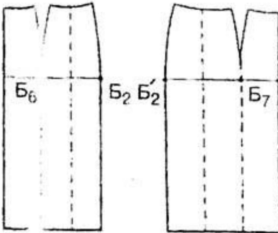
По осевым линиям вытачек переднего и заднего полотнищ, а также через середины отрезков Б6Б2 и Б2Б7 провести вертикальные прямые линии до их пересечения с линией низа.
