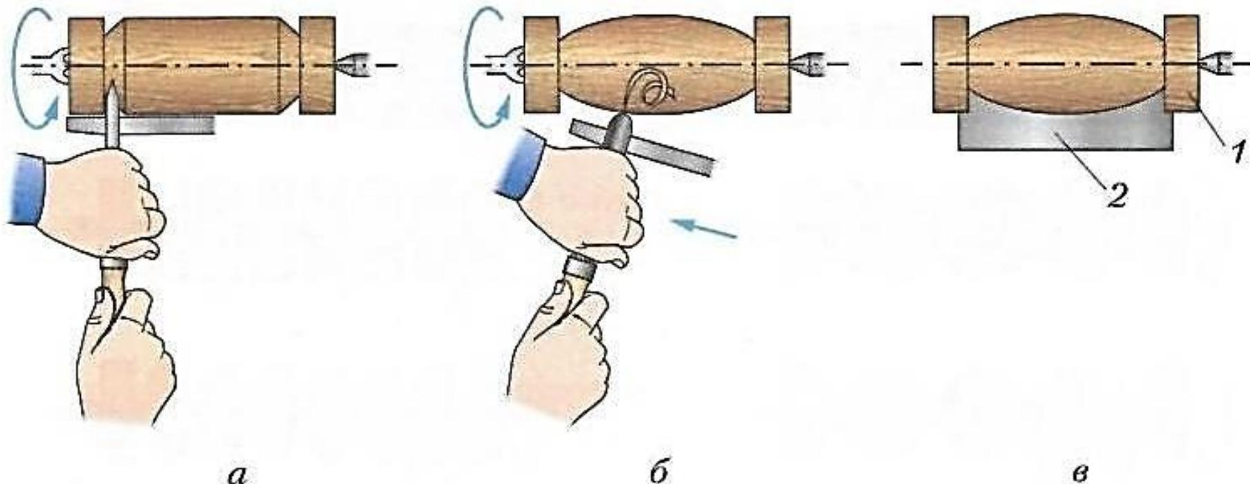
Обработка выпуклой поверхности: *а* – подрезание внутренних торцов; *б* – черновое точение; *в* – проверка формы поверхности шаблоном:
