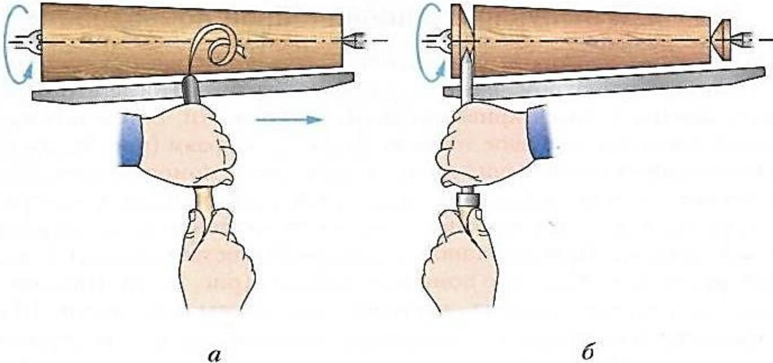
Обработка конической поверхности: *а* — обточка конуса; *б* — подрезка торца
