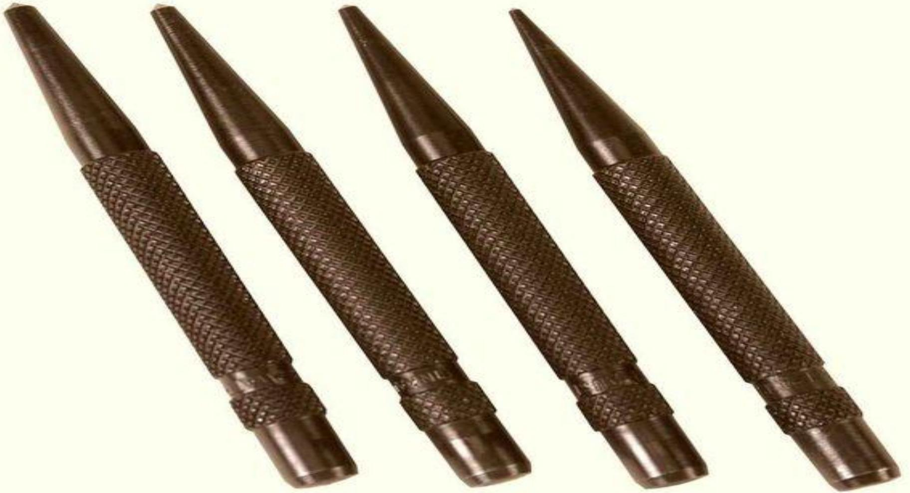
Прежде чем сверлить отверстие, нужно разметить и накернить их центр. Нужно это для того, чтобы сверло при работе не, «уходило» в сторону и отверстие получилось строго определенных местах. ( Кернер )
